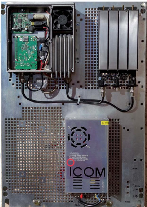
est voué à prendre place sur le site de La Croix de Toulouse, situé à 2000 mètres d'altitude. Ce relais UHF y bénéficiera d'une alimentation secteur en 220 volts. Quant à l'ADSL, cette connexion à Internet repose sur une liaison obtenue par un link 5,675 GHz. Question autonomie et protection contre les micro coupures, un onduleur a été prévu.
