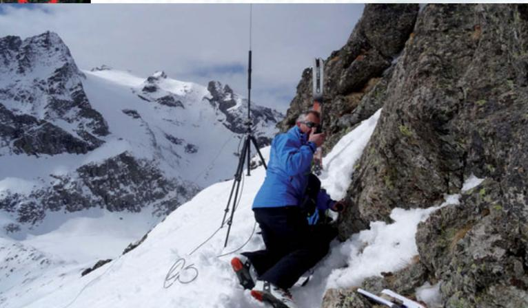
il bénéficie d'une plage d'utilisation importante, car elle peut fonctionner entre le 40 mètres et le 400 MHz. ... Compte tenu de la proximité immédiate du transceiver, la longueur de coaxial entre l'antenne et ce dernier sera limitée à quelques mètres. Donc, sans entraîner de perte significative.
