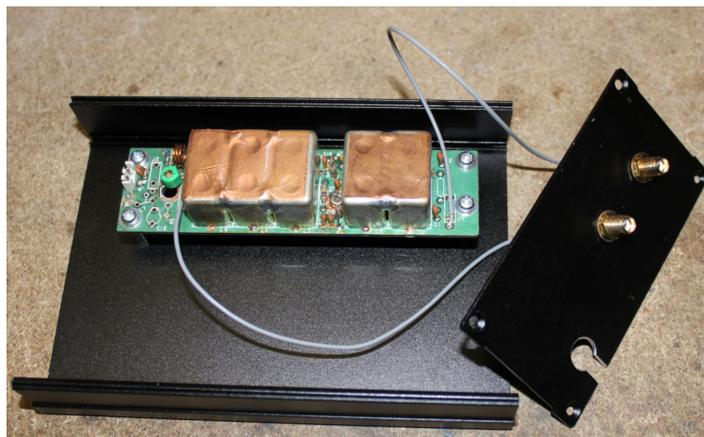
**Mise en place du Préampli avec l'entrée/sortie sur SMA**
