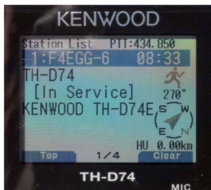
les plus proches de votre position, à environ 150 Kms avec le GPS sur ON ou la position manuelle enregistrée) ; Auto Reply.
